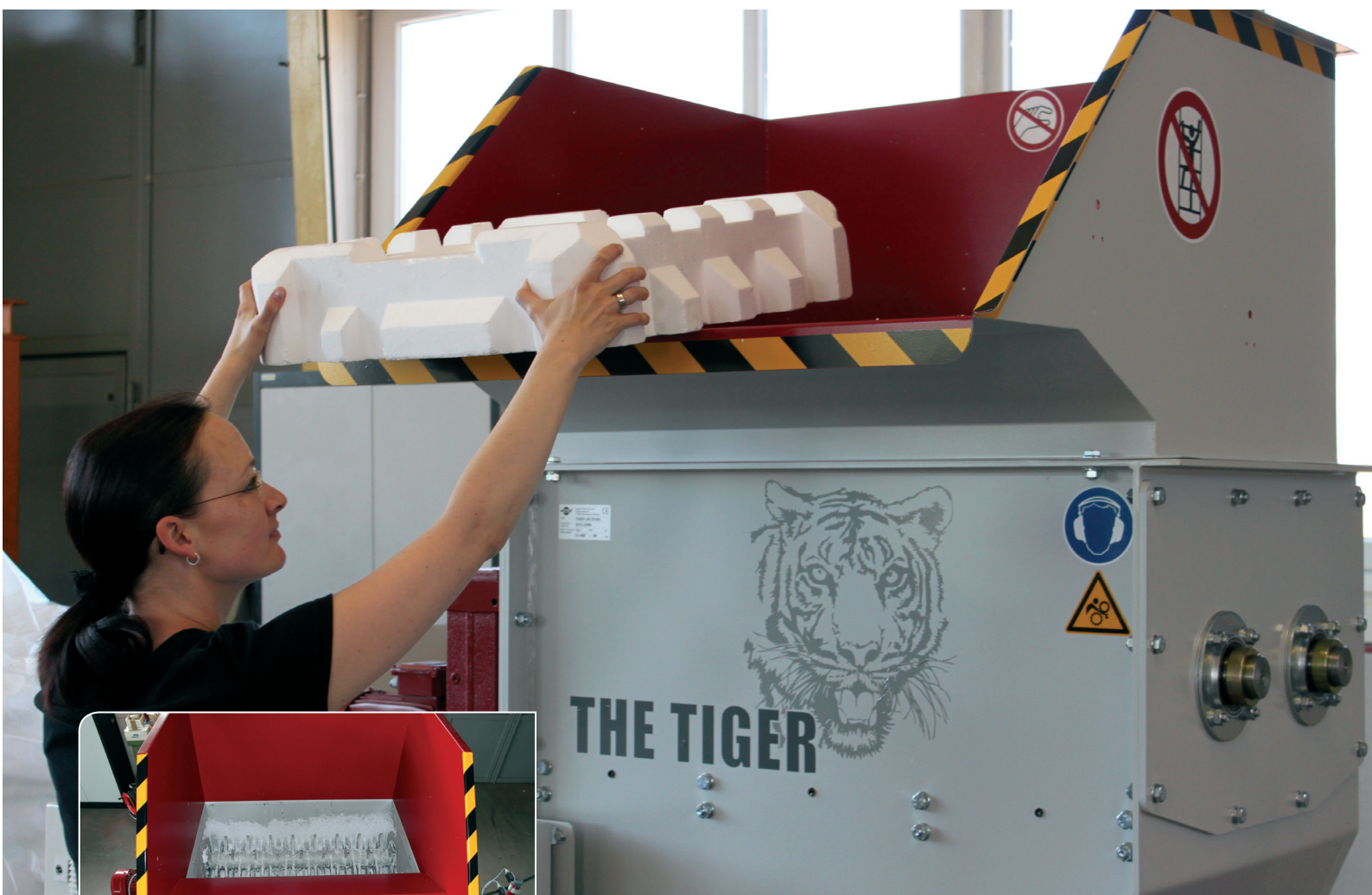
En effektiv grovkvärn med tvåtandade roterande axlar
